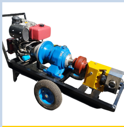
پمپ دیزلی قابل حمل Diesel Driven Transfer Pump
